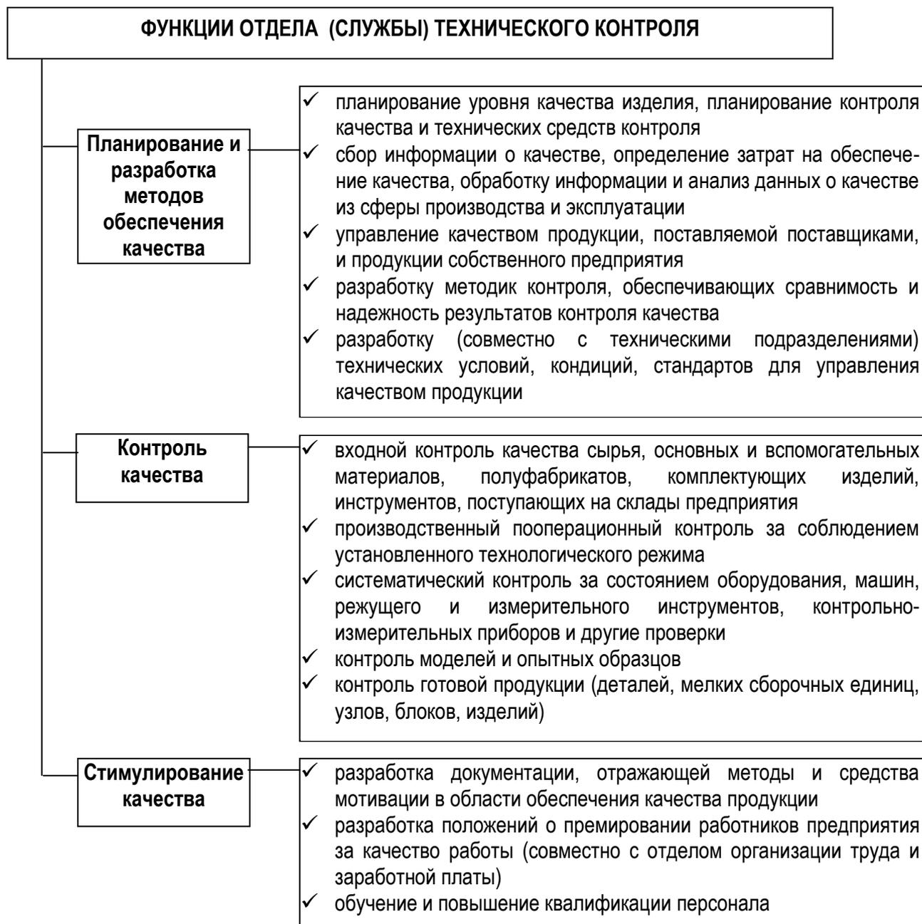
Рис. 55. Функции отдела технического контроля
